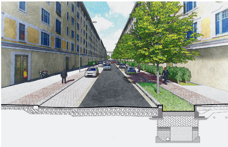
Abb. 7: Baumrigolen mit unterirdischer Abdichtung in der Kasseler Straße in Leipzig.
