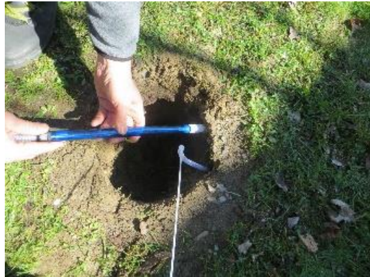
Abb. 3: Messprinzip, Installation der Saugkerzen und Monitoringstation
