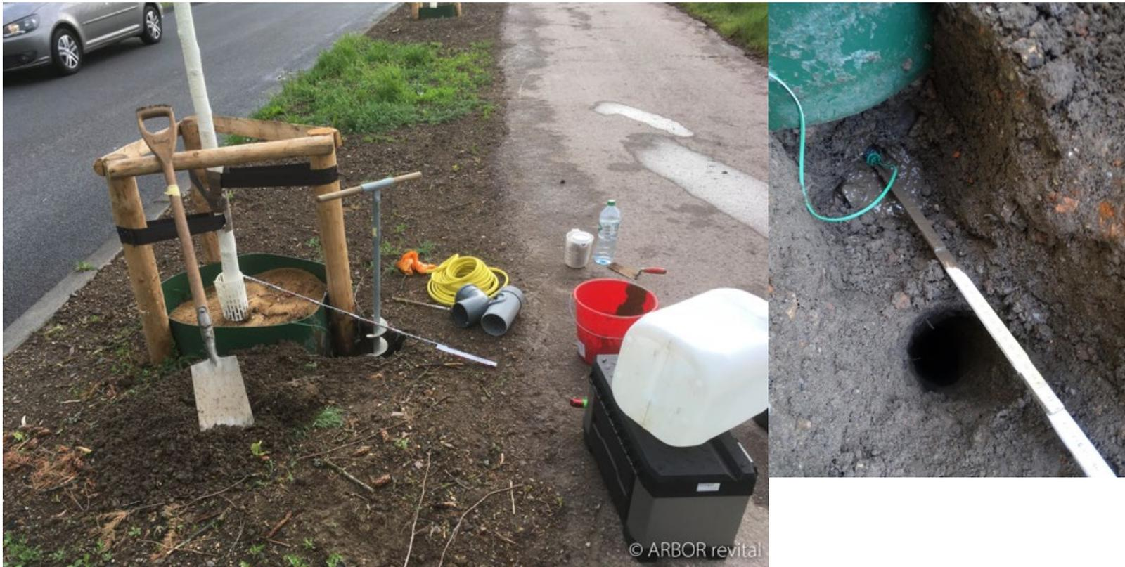
Einbau der 20 Sensoren in den Wurzelballen und den Substratkörper mit leichtem Gerät innerhalb eines Arbeitstages möglich. Aufnahme: 25.04.2019
