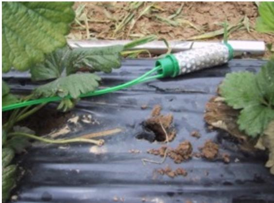
Watermark Sensor. Messung der Wasserspannung (0 bis 199 kPa/cbar) (Quelle: MMM-Tech)
