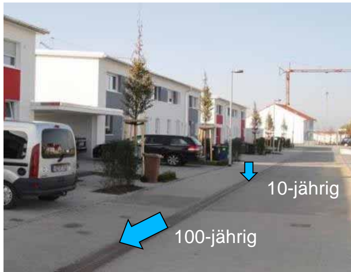
oberflächennahe Kombinationsmöglichkeiten mit Grünmuldensystemen
