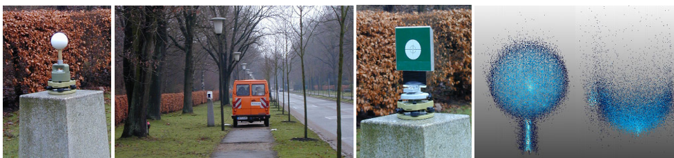
Abb. 4: v.l.n.r. Kugel auf Pfeiler, Scanner auf Eichstrecke, Zieltafel auf Pfeiler und Streuung einer Kugel-Punktwolke von vorn und von oben
