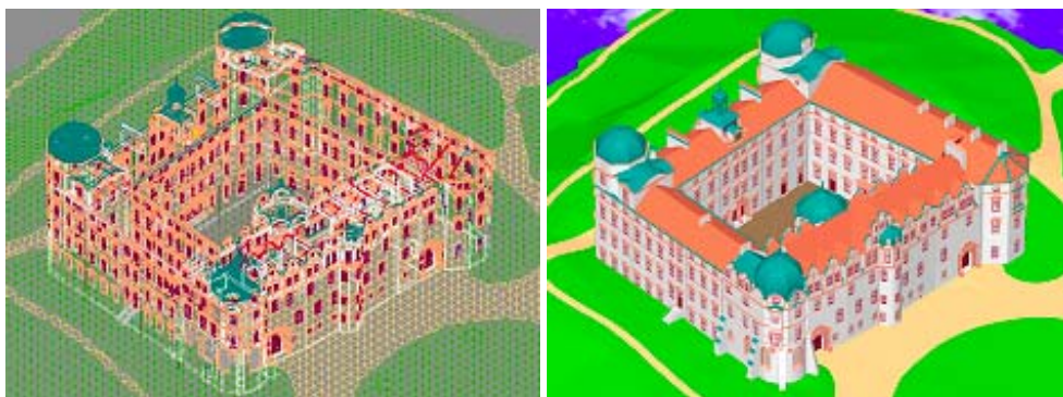
Abb. 6: 3D-Volumenkörper des Celler Schlosses als Drahtmodell (links) und gerendertes Modell (rechts)
