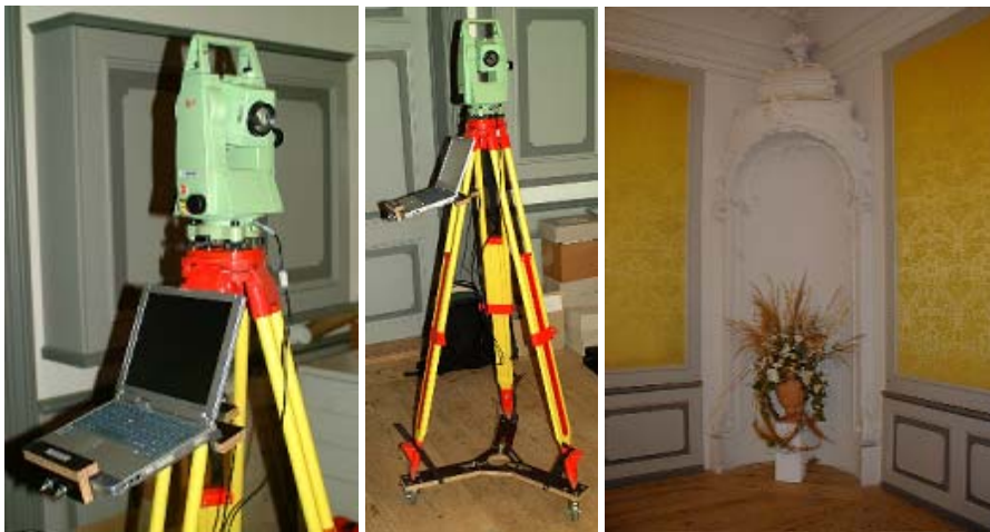
Abb. 8: Innenaufmass mit dem Meßsystem Vitruvius; Raumausschnitt Drostei Pinneberg
