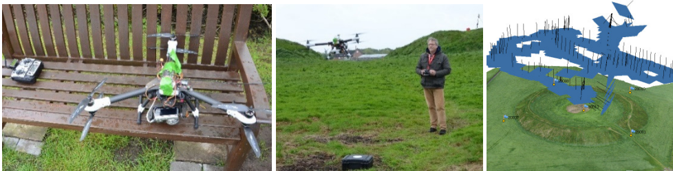
Abb. 3: Der Hexacopter Sky Hero Spy 750 (links), Start des Hexacopter für die Aufnahme (Mitte) und Aufnahmekonfiguration mit Passpunkten (rechts).
