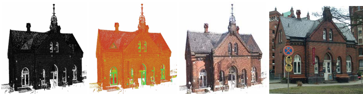
Abb. 2: v.l.n.r. Intensitätsbild als Grauwertdarstellung und farbig vs. RGB-eingefärbte Punktwolke (alle vom Laserscanner GS100) sowie Farbbild (Fuji S2) des Fleetschlösschens in der HafenCity Hamburg
