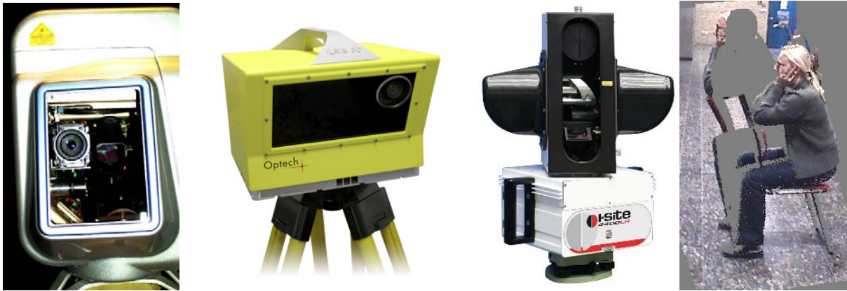
Abb. 6: Integrierte Kameras in terrestrischen Laserscannern: v.l.n.r. Trimble GS200, Optech ILRIS-3D, I-Site 4400LR mit integrierter Panoramakamera, sowie Auswirkungen der Parallaxe zwischen Scannerspiegel und Videokamera im nahen Scanbereich
