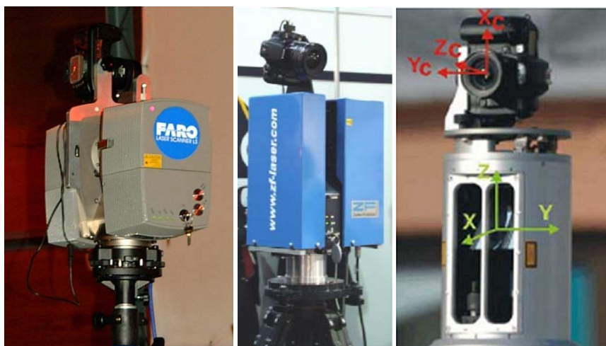
Abb. 7: Terrestrische Laserscanner und adaptierte digitale Kameras: v.l.n.r. Faro LS 880HE, Zoller & Fröhlich Imager 5003 und Riegl LMS Z-Serie
