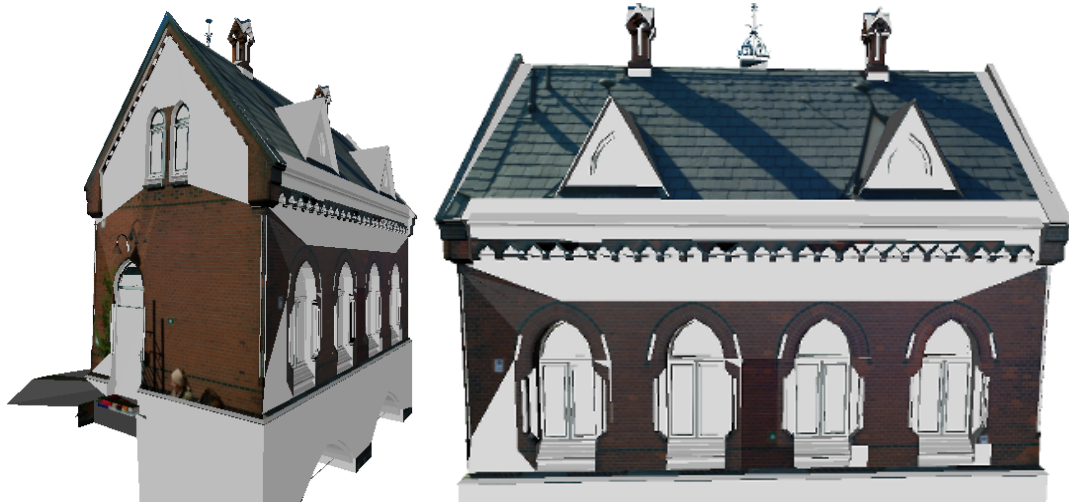
Abb. 12: Ergebnis der automatischen Texturierung für das 3D-Modell des Fleetschlösschens in Hamburg-HafenCity – Problem: Dreiecke ohne Textur bei Verwendung der Sichtbarkeitsanalyse vor der automatischen Texturierung
