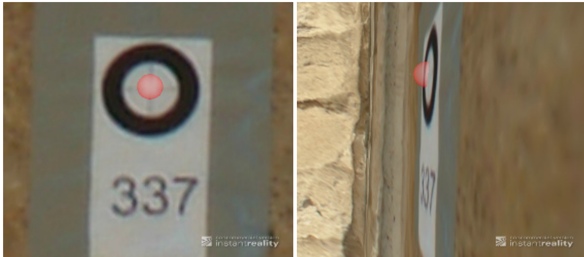
Abb. 8: Überlagerung des texturierten 3D-Modells mit Passpunkten zur geometrischen Qualitätskontrolle
