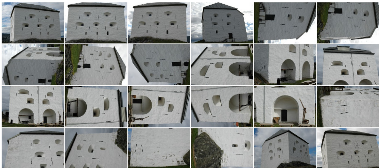
Abb. 9: Übersicht der 24 verwendeten Bilder für die automatische Texturierung des 3D-Modells der Kristiansten Festung
