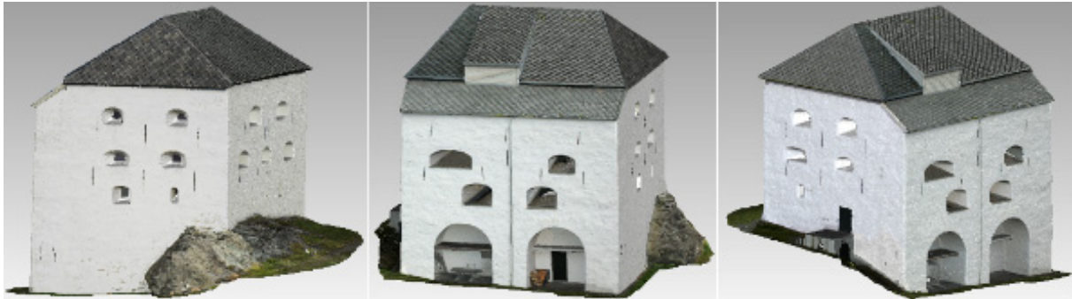
Abb. 2: Verschiedene Ansichten des Kristiansten Festungsgebäudes in Trondheim – Aufnahme durch Riegl VZ-400, Dreiecksvermaschung und Texturierung mit Geomagic
