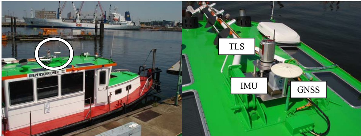
Abb. 10: Installation des TLS Riegl VZ-400 an Bord der „Deepenschriewer III“.
