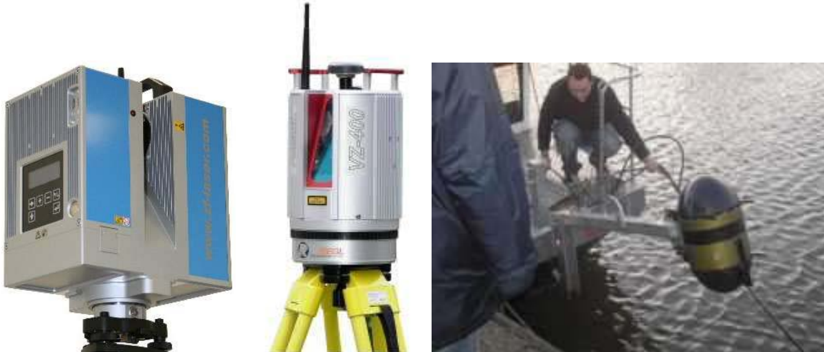
Abb. 3: Z+F IMAGER 5006i (links), Riegl VZ-400 (Mitte) und Reson SeaBat 8101 (rechts)
