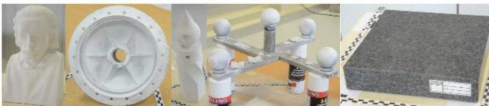
**Abb. 2:** Test- und Referenzkörper für die Untersuchungen der handgeführten Scannersysteme – v.l.n.r. Einstein-Büste, Radnabe, Testy, Referenzkörper HSBO mit Kugeln und Granitplatte.
